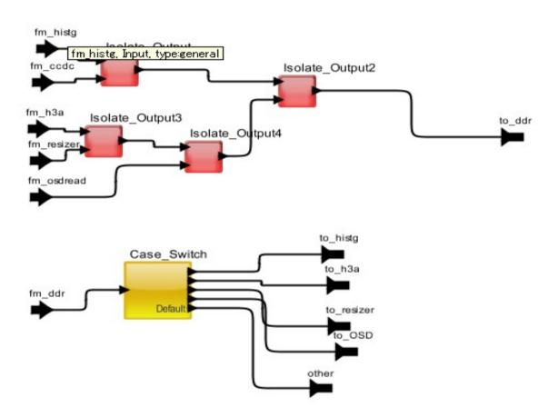
下記にBuffer内部の構成図を示す。Bus->メモリ(DDR)のデータを一旦保存し、各ブロックからのアクセスが破綻しないように調整する。 また、バス幅合ったデータ転送を制御する。動作は、ライト及びリード双方に対応。
