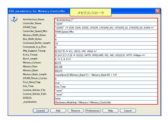
メモリは、"HW\_DRAM"ブロックのメモリと"Memory\_Controller"ブロックのスペックはバス幅接続、周波数以外は、仮のスペックでの設定。
