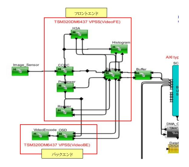
下記に CCDC 内部の構成図を示す。イメージセンサーより、入力されたデータを DDR 及び関係各部へ送る。現在は、要求仕様の通り DDR へ直接ライトするパス 設定となっている。
